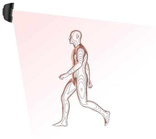
El detector se debe instalar a 2,4 metros sin obstruir su visión. Por ejemplo, en una esquina donde no se bloquee su visión con un armario u otros muebles a los que una mascota puede subir.
