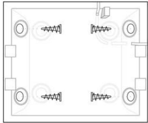
8. Fije el detector en el panel de montaje SmartBracket.
