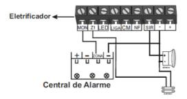
Obs: Para a ligação do eletrificador em um painel monitorável, deve-se utilizar o resistor de fim de linha (que acompanha o painel monitorável).
