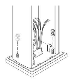
Acoplar el cubre-enganche del mástil, la placa intermedia y la placa del árbol motor utilizando un tornillo. No apretar del todo el tornillo para facilitar la colocación del mástil.
